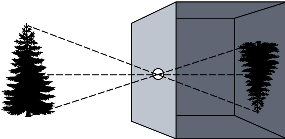
Un diagrama de un proyector estenopeico simple. La luz reflejada por el árbol de la izquierda se enfoca a través de la abertura estenopeica y se refleja al revés en la parte posterior de la caja.
